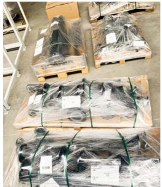
Vorgefertigte Rohrbaugruppen zur Herstellung einer modularen Energiezentrale
