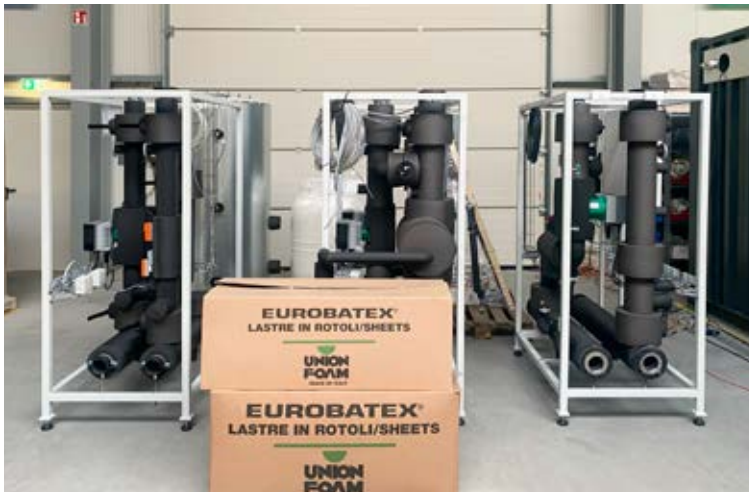
Abholbereite Modulbaugruppen für eine Energiezentrale
