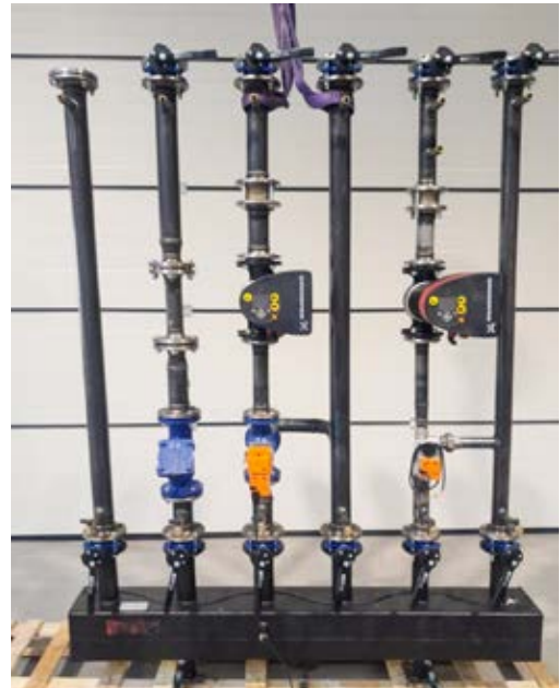
Vorgefertigter Energieverteiler für ein Projekt in Bulgarien
